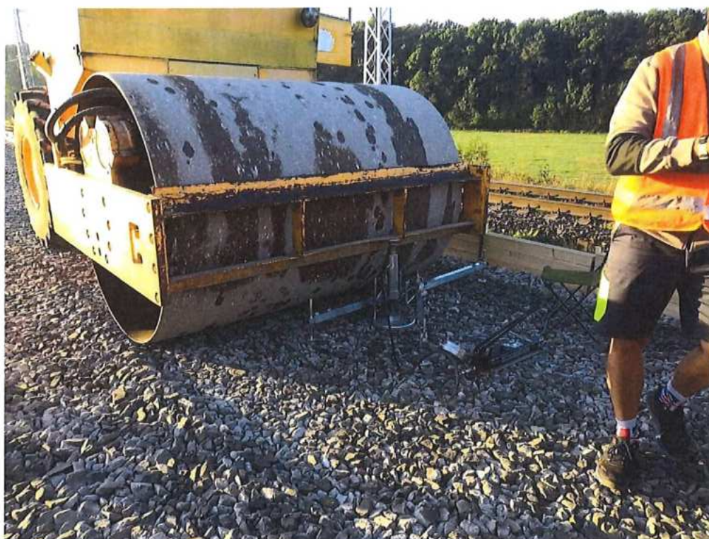
Statická zať. skúška žel. zvršku
